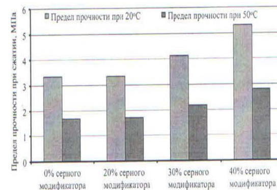
Рисунок 1 – Гистограмма изменения прочности образцов на сжатие при 20 и 50 °С (образцы испытаны после 2-суточного хранения)
