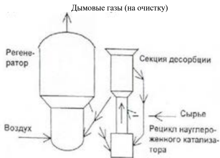
Рисунок 3 – Реакторно-регенераторный блок установки каталитического крекинга PetroFCC
