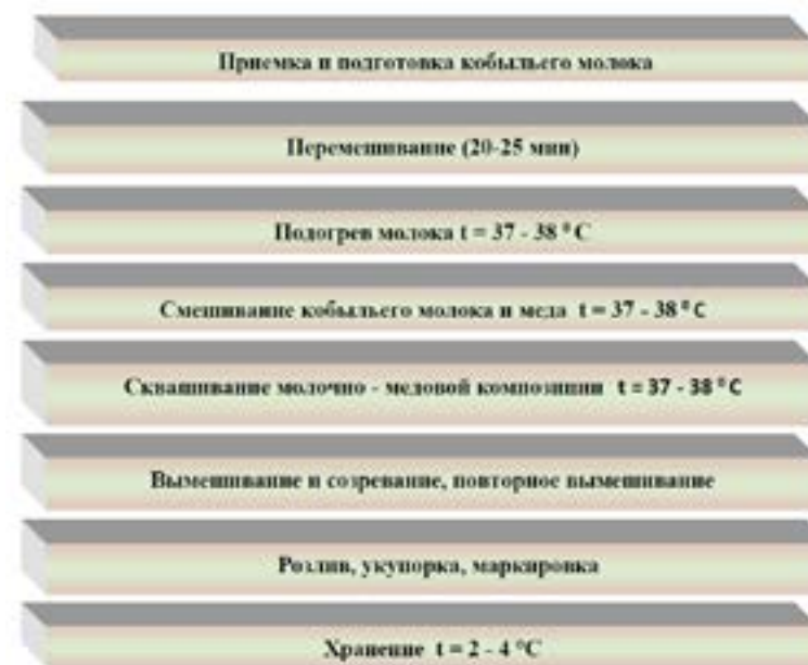
Рисунок 2 – Блок – схема технологического процесса производства балкумыса
