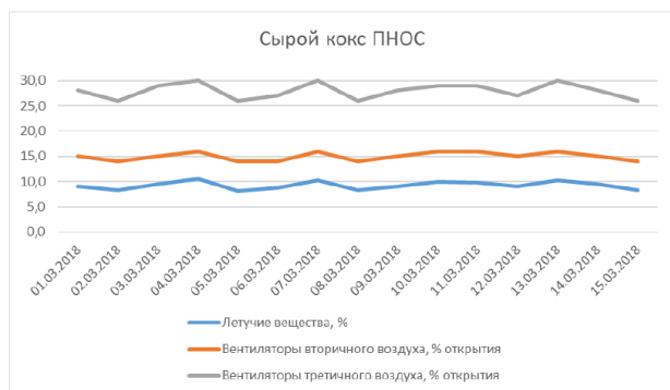
Рисунок 6 – График зависимости подачи вторичного и третичного воздуха от массовой доли летучих веществ в СНК ПНОС
