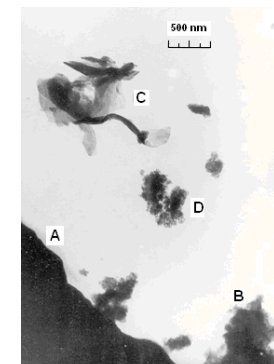
А – Ровный край кристалла носителя, лишенный полимерного покрытия; В – Край плотного кристалла алюмосиликата с закрепленным ПМК; С – Отделившаяся от подложки частица полимера; D – Полимерметаллический комплекс не связанный с носителем Рисунок 5 – Отработанный катализатор Mn_2[Fe(CN)_6]-PDMDAAC/Siral-40 \times 24000
