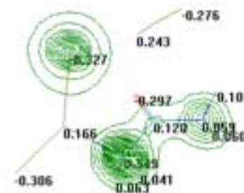
Рисунок 2 – Схема распределения эффективных зарядов в молекуле ZnBr_2 \cdot CO(NH_2)_2 \cdot HBr
