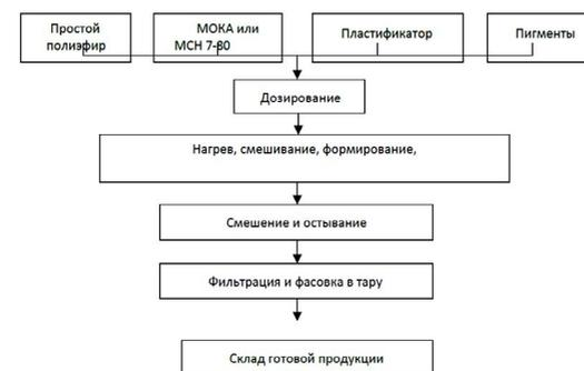
Рисунок 1 – Технология производства гидроксилсодержащего компонента покрытия
