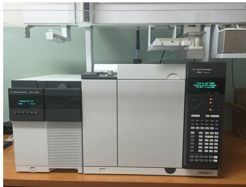
Рисунок 4 – Газовый хроматограф Agilent 7890 В с масс-селективным детектором 5977 А
