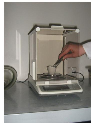
Рисунок 2 – Гравиметрический метод
