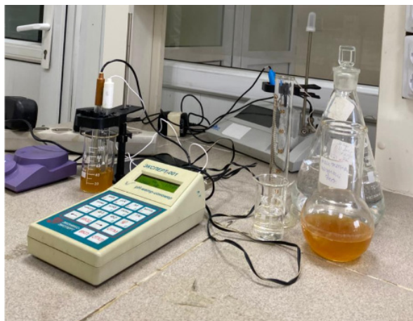
Рисунок 2 – Установка ионометрического определения ионов натрия
