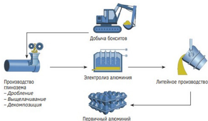
Рисунок 1 – Схема производства первичного алюминия
