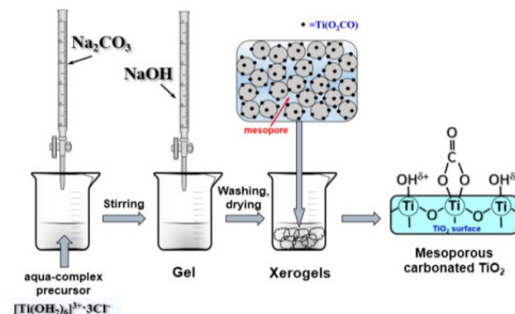
2-сурет – Мезокеуекті құрылымы бар \text{TiO}_2 карбонатының синтезінің схемалық диаграммасы [5].
