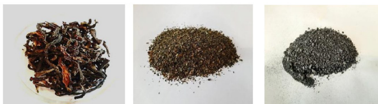
Рисунок 2 – Высушенные (а), измельченные (б) и карбонизованные (в) образцы огуречных кожуры
